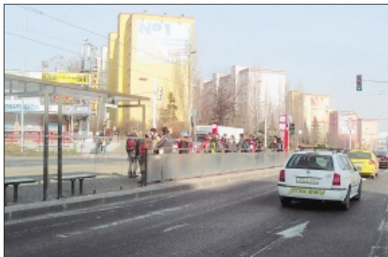
Nejfrekventovanější zastávka na Evropské má zábradlí a rozšířenou refěž. Zúžila se vozovka o část jednoho pruhu.
