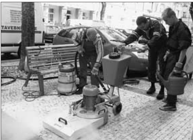
Specializovaná firma předvedla zástupcům radnice nové stroje na čištění chodníků. Pomocí horké páry a čistící emulze se z mozaiky jednoduchým způsobem odstraní špína, ale například i nalepené žvýkačky. Radnice zvažuje, že tímto způsobem nechá umýt některé chodníky v Praze 6.
